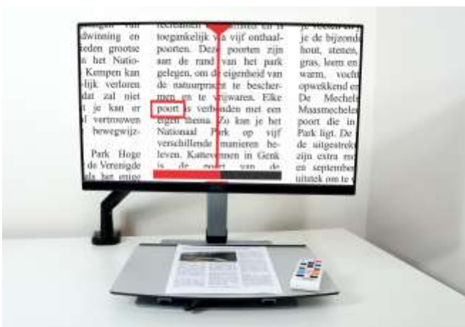
ZoomCam met schuiftafel waarbij het scherm op een monitorarm hangt. De centrale montage van het scherm zorgt voor een opstelling zoals een gewone beeldschermloop.
