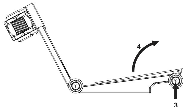
5. Drehen Sie die Zoomcam und setzen Sie die ZoomCam auf die Fußplatte.
